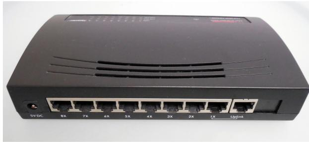
Los hubs en realidad son repetidores multipuerto. En muchos casos, la diferencia entre los dos dispositivos radica en el número de puertos que cada uno posee. Mientras que un repetidor convencional tiene sólo dos puertos, un hub por lo general tiene de cuatro a veinticuatro puertos normalmente, y repite la señal a todos los puertos menos el de origen
