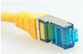
El conector RJ-45 definido por ISO 8877 se utiliza para diferentes especificaciones de la capa física en las que se incluye Ethernet. Otra especificación, EIA-TIA 568, describe los códigos de color de los cables para colocar pines a las asignaciones (diagrama de pines) para el cable directo de Ethernet y para los cables de conexión cruzada.
