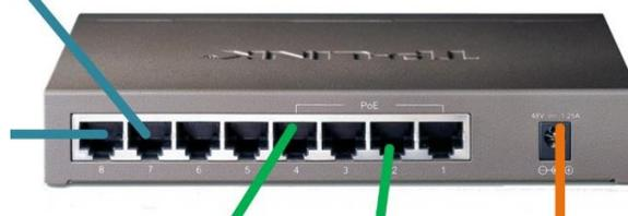
Este switch tiene una toma de corriente (naranja) por donde se alimenta, 4 puertos (8,7,6,5) normales, 4 puertos PoE (4,3,2,1) donde podemos conectar dispositivos que necesiten alimentación a través del cable RJ-45.
