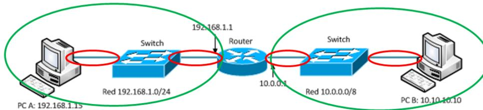
Un switch es un dispositivo de interconexión de nivel 2 que es capaz de generar diferentes dominios de colisión. La diferencia entre un hub (concentrador) y un switch (conmutador) es que un hub recibe información por un puerto (conexión) y la reenvía por todos los demás mientras que un switch reenvía la información solamente por los puertos a los que va dirigida.
