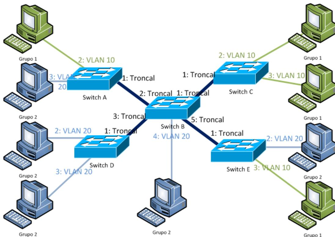
Para redes extensas existen protocolos, como VTP o MVRP, que permiten administrar las VLANs de forma centralizada. Utilizan un switch como servidor, donde se crean las VLANs y se administran, los demás switches se configuran en modo cliente, "aprenden" del switch servidor.
