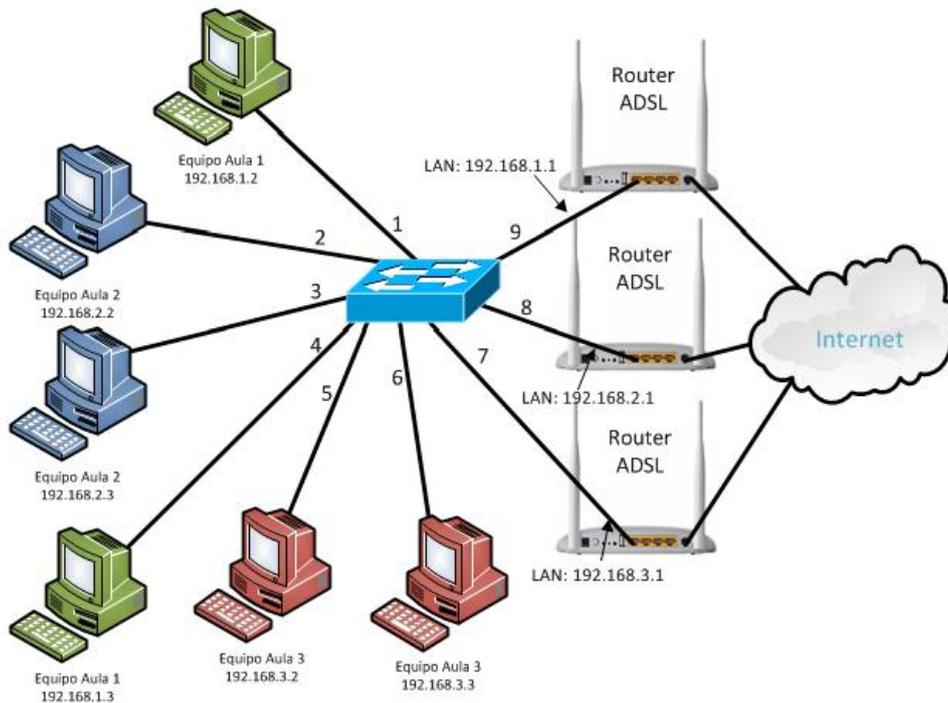
Esta solución no utiliza VLAN, es a base de configuración IP de los dispositivos, asignamos IPs a dispositivos formando tres redes independientes, por ejemplo 192.168.1.0/24 (aula 1 y router ADSL 1) 192.168.2.0/24 (aula 2 y router ADSL 2) y 192.168.3.0/24 (aula 3 y router ADSL 3). El inconveniente de esta solución es que como todos los dispositivos están conectados a puertos de la VLAN predeterminada y los usuarios pueden manipular la configuración IP podrían acceder entre aulas.
