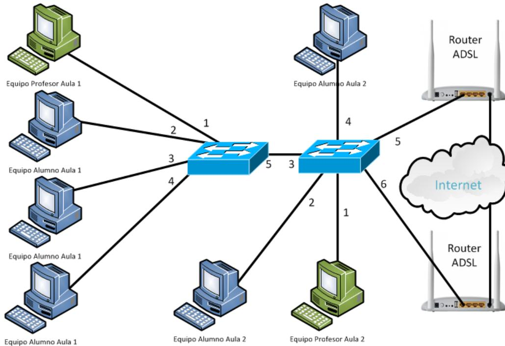
Seguiría siendo válida una solución basada en dos redes IPs diferentes con el inconveniente de que el alumno podría cambiar la configuración IP de su equipo y acceder a la ADSL y los equipos de los profesores.
