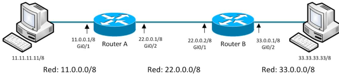
En el router A hay 2 redes conocidas por el propio router porque están conectadas directamente y el propio router las añadirá automáticamente a su tabla de enrutamiento. El administrador de la red solo tendrá que configurar el router añadiendo la ruta hacia la red no conocida 33.0.0.0/8, para ello indica el siguiente paso para llegar a ella, es decir, indicar hacia que punto debe enviar los paquetes con destino a esta red.
