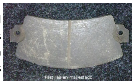
Pastillas en mal estado Máximo González. CC by. Elaboración propia.
