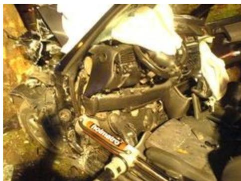
Pistón hidráulico en una extracción.
