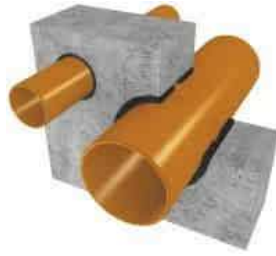
Junta de dilatación en tuberías pasantes (CCO)
