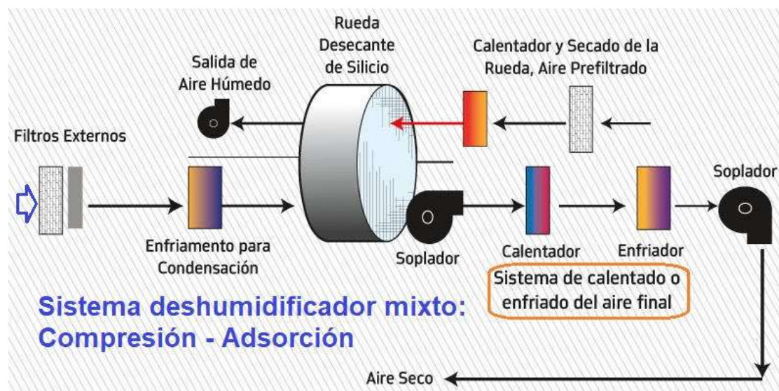
Sistema mixto de deshumidificación
