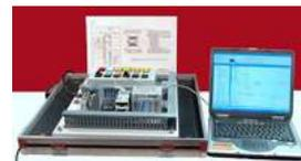
El **interface de comunicación con PC** es un dispositivo que funciona como **traductor** entre el lenguaje que utilizan los **ordenadores** y el de los **autómatas**.
