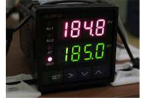
Además del control tipo **todo-nada** en el que el sistema se enciende o se apaga siguiendo las órdenes del controlador también se puede utilizar el **control proporcional** en el que el sistema se regula en función de la proximidad a los valores de consigna de la instalación.
