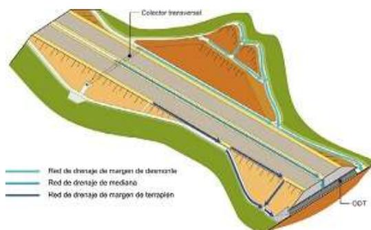
En la imagen vemos coloreadas en azul las diferentes redes de drenaje longitudinal de una carretera y marcadas como ODT y colector transversal los drenajes transversales.
