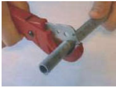
Hay que tener en cuenta que el cortatubo genera una rebaba en la cara interior del corte. Es por ello que ha de realizarse siempre una operación de escariado para eliminar dicha rebaba, evitando así que se generen problemas en las posteriores operaciones de conformado y unión de los tubos. Los escariadores más empleados son los mostrados en las figuras adjuntas.
