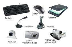
El funcionamiento de los dispositivos de entrada es captar la imagen o el sonido y convertirlo en <u>señal</u> digital manipulable por el ordenador. Los dispositivos que nos permiten conectarnos a la red adecuan la <u>señal analógica</u> que toman de las líneas telefónicas a una señal digital y al contrario cuando nuestro ordenador va a mandar información a las líneas del teléfono este la convierte en señal analógica.
