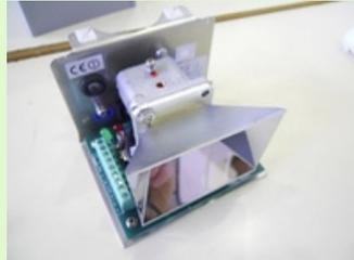
Los **detectores de intrusión** son elementos que, conectados a la central del sistema de alarmas, son capaces de comprobar las variaciones de una condición de reposo en un lugar específico, como cambios de temperatura, movimiento o nivel de vibraciones y comunicar esa información a la Central de Alarmas.
