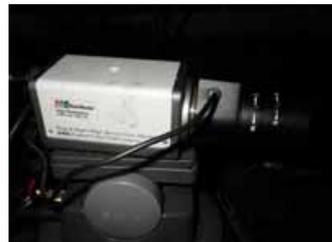
A veces, dadas las características de las instalaciones, nos interesa que una misma cámara abarque zonas en direcciones opuestas y para ello habrá que dotarla de un sistema que permita el giro de ésta. Normalmente, el motor de rotación lleva un dispositivo que permite el acople de la cámara o de la carcasa si las condiciones requieren el uso de éstas. Actúan como base situada entre el soporte y la carcasa. Dependiendo de las características del modelo admite varios modos de trabajo.
