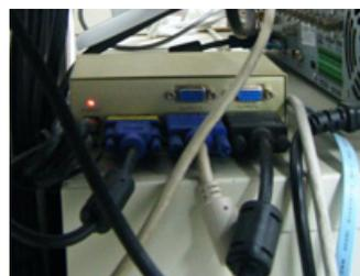
También existen en el mercado distribuidores de videos con varias entradas y varias salidas, por ejemplo 4 entradas y 12 salidas o de 8 entradas y 24 salidas, que permitirían replicar cada una de las entradas en tres salidas independientes. Estos equipos no necesitan ningún tipo de configuración y su alimentación la pueden tomar directamente de la red. Las entradas y salidas de las señales de videos vienen con impedancias de 75 ohmios.
