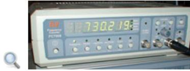
El frecuencímetro es un instrumento que mide la frecuencia, basándose en el funcionamiento de un contador que contabiliza el número de repeticiones de una onda en un intervalo de tiempo. El valor de esta frecuencia aparece en un display en las unidades del S.M.I. (Hertz).
