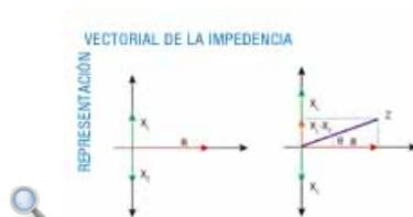
**Impedancias mixtas:** Resistencia y condensador. En este caso, la impedancia se expresa como la suma de dos vectores R y  $X_C$ ;  $Z = R - jX_C$ . El ángulo de desfase  $\phi = \arctg\left(-\frac{X_C}{R}\right)$ .
