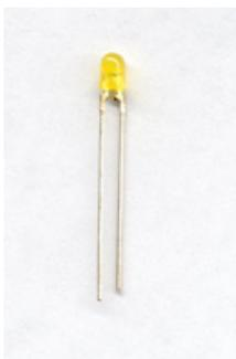
Los diodos LED se fabrican con elementos especiales, como arseniuro de galio y fósforo. Según el material con el cual fueron construidos pueden ser de diversos colores, rojo, verde, amarillo, ámbar, infrarrojo, etc.
