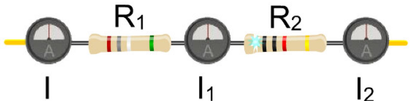
Si aplicamos una tensión  $V$  entre sus extremos, la suma de la caída de tensión en cada resistencia es igual a la tensión total aplicada.
