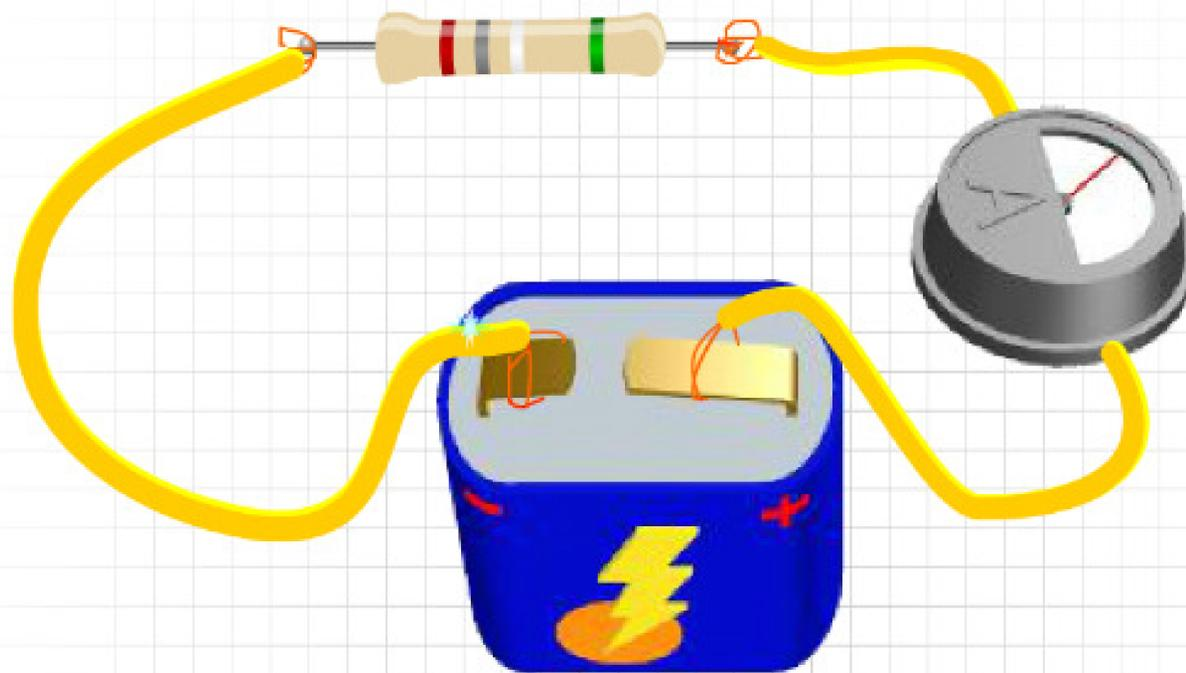
La intensidad de la corriente eléctrica que circula por una resistencia viene dada por la Ley de OHM y es directamente proporcional a la tensión aplicada e inversamente al valor de la resistencia.
