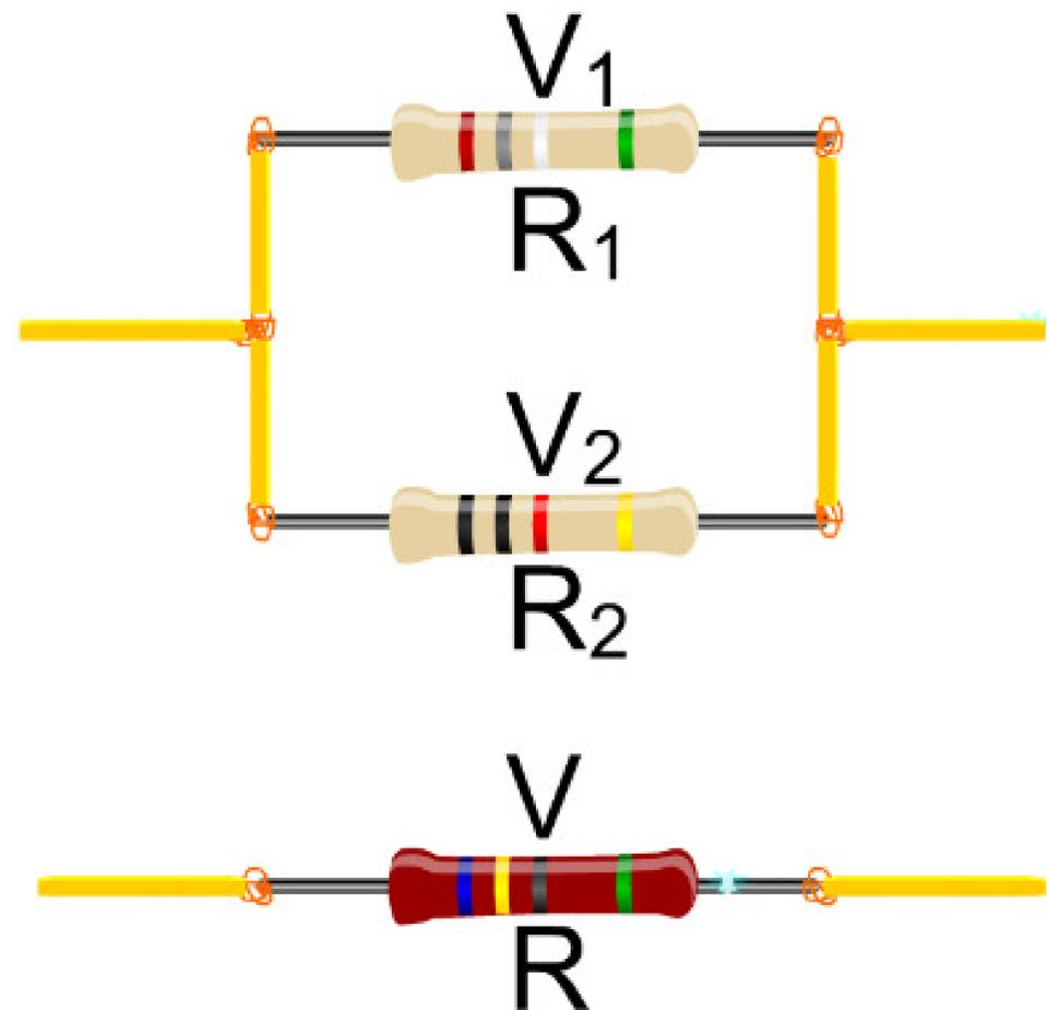
Si disponemos de varias resistencias en paralelo, la inversa de la resistencia equivalente es igual a la suma de las inversas de cada resistencia.
