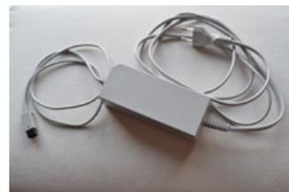
Ante este suministro, los equipos se pueden conectar directamente a ella o a través de una fuente de alimentación que transforma los 230 V de corriente alterna en 12 V o 24 V de corriente continua.
