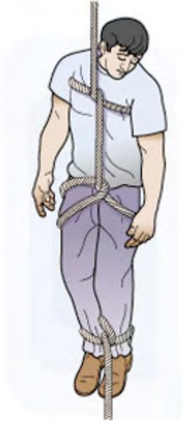
Figura 7-101: Izado con un cabo.
