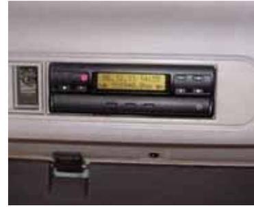
A modo de definición, podemos decir que el tacógrafo es el **aparato de control y registro automático de datos sobre la marcha de algunos vehículos y sobre los tiempos de trabajo y descanso de sus conductores**, es decir los que acabas de ver en los puntos anteriores.
