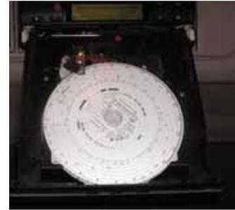
El tacógrafo analógico es un tipo de aparato de control que **registra la actividad mediante la impresión de unas marcas que indican la actividad realizada en unos discos de papel especial.**
