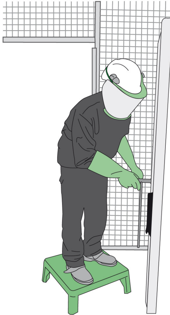
Figura 14. Colocación de la puesta a tierra en una instalación de alta tensión
