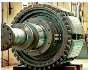
Blog Profesor Galindez. Rotor de polos salientes (CC BY-NC-SA)
