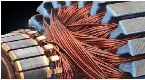
Wikipedia . Rotor devanado o de anillos rozantes (CC BY-NC-SA)
