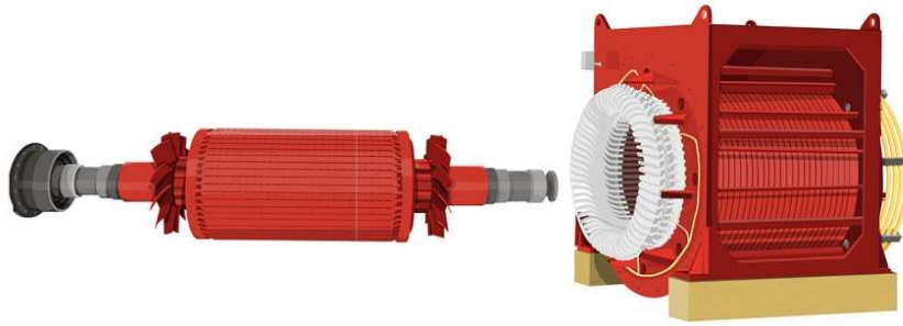
Endesa. Detalle de un generador eléctrico (CC BY-NC-SA)
