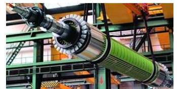
Blog Profesor Galindez. Rotor de polos lisos (CC BY-NC-SA)
