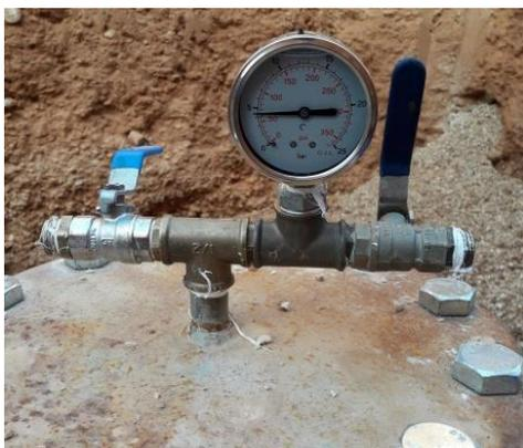
Se procederá a incrementar la presión hasta la presión de funcionamiento (OP) sin exceder la presión de la prueba de la red (STP).
