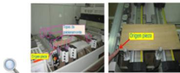
El origen pieza es la referencia principal donde apoyas la pieza y sirve para conocer el punto que toma como referencia la máquina para mecanizar. La programación de las piezas es igual, aunque sus orígenes pieza sean diferentes. El origen pieza, si miras a la máquina de frente, suele ser la esquina inferior o superior del lado izquierdo del [area ó campo de trabajo de la máquina](#).
