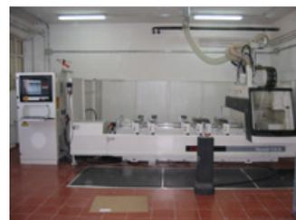
Las máquinas por excelencia y más complejas a CNC son los **centros de mecanizado**, este tipo de máquina supone en sí misma una revolución en cuanto a concepción del trabajo ya que sin mover la pieza podrás hacer todos los mecanizados posibles.
