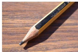
Su dureza se determina en función de las distintas proporciones de la mezcla, clasificándose con el siguiente código: B = blando; H = duro; HB = medio, pasando desde el B8 por el HB hasta el H8, en función de su dureza, clasificándose tal como muestra la siguiente tabla.
