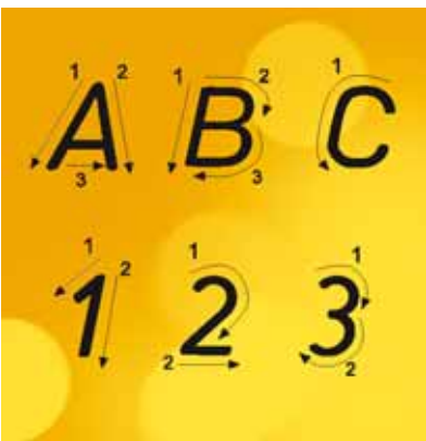
Ejemplo de rotulación normalizada inclinada.
