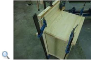
Comprueba siempre, que dispones de todos los elementos que intervienen en el montaje, antes de aplicar el adhesivo.
