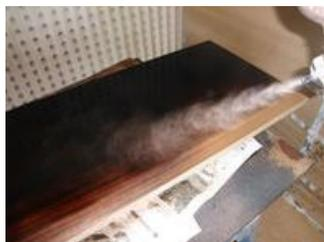
En la imagen superior puedes observar la regulación de la pistola aerográfica, pudiendo controlar el parámetro de cantidad de producto y abanico de aplicación, la presión de aplicación es habitual realizarla en el manómetro del filtrado de aire, aunque existen pistolas que también incorporan esa posibilidad.
