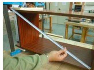
Para comprobar los ángulos en prototipos en forma de rombo, romboide o trapecio utiliza la falsa escuadra y comprueba que los ángulos opuestos en rombos y romboides son iguales, en trapecios regulares, por ejemplo un mueble en forma de escalera, comprueba que los ángulos contiguos en baldas horizontales sean iguales.
