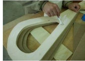
Recuerda la valoración que debes realizar para elegir el tipo de adhesivo que utilizarás en el encolado de los elementos del prototipo, tan importante como sus características y propiedades es que conozcas los útiles de aplicación, las secuencias de aplicación del adhesivo, el prensado o apriete y la comprobación de parámetros en encolado.
