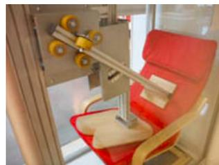
**¿Qué ensayos mecánicos debes de realizar a un prototipo?**, todos aquellos que te provean de datos para determinar si el prototipo cumple con una serie de requisitos exigibles para poder lanzar el producto al mercado, dicho así parece sencillo, pero se complica si debes certificar una calidad total del elemento y que va más allá de la **trazabilidad** del prototipo, en concreto te pongo dos ejemplos:
