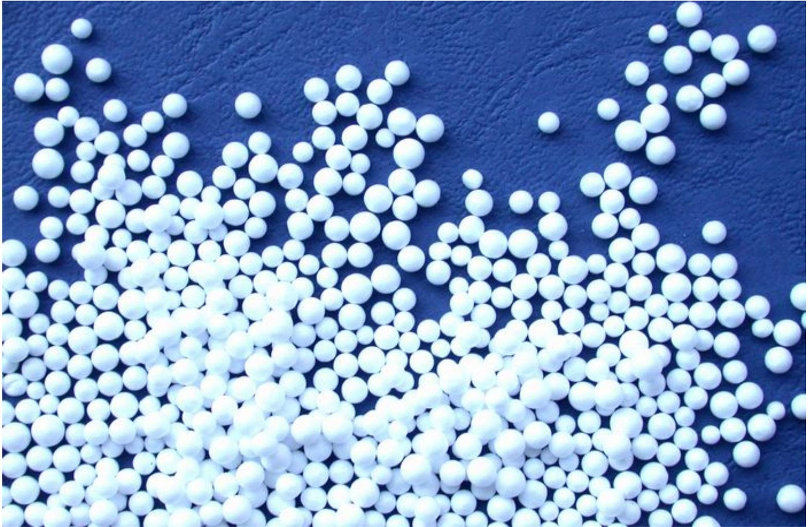
Material de relleno, las opciones más utilizadas son cubitos de poliestireno expandido, emprolith (gusanitos), máquinas de hinchado de bolsas de aire, máquinas de papel, poliuretano. En la imagen puedes ver bolitas de poliestireno.
