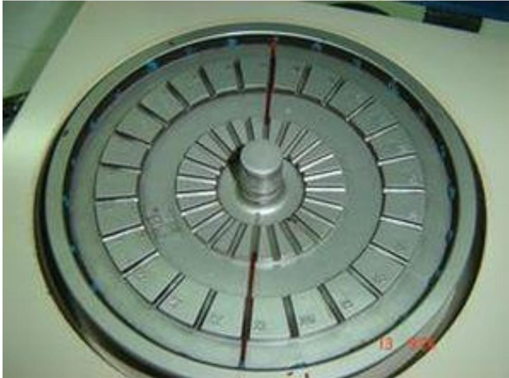
4.- Coloca los capilares en el plato de la centrífuga: enfrentados, por pares y con el extremo con plastilina hacia el exterior para evitar la salida de la sangre.
