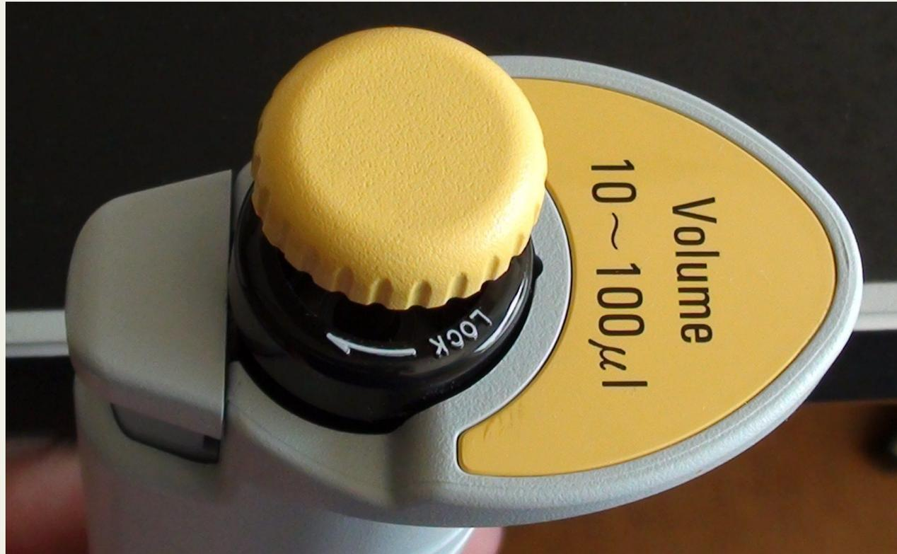
Todas las micropipetas regulables tienen un dispositivo (rueda) para seleccionar el volumen que se desea coger.
