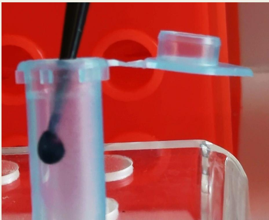
Al introducir la punta de la pipeta en el tubo, colócala **tocando la pared lateral** del mismo. De esta manera podrás ver el volumen que has dispensado.
