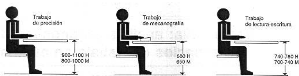
Fig. 1: Altura del plano de trabajo para puestos de trabajo sentado (cotas en mm)
